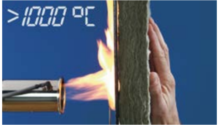
Steinwolle von Flumroc hat einen Schmelzpunkt von über 1000°C.
